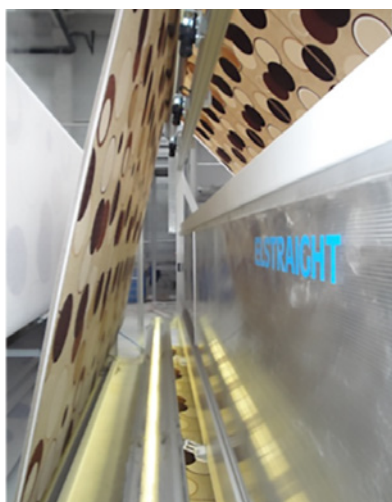
Cámara de matriz a color en instalación de producción de alfombras
