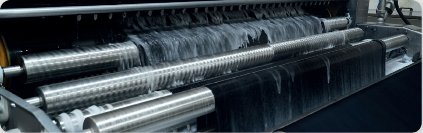
Enzim Yıkama Ünitesi / Enzym Wash Unit
